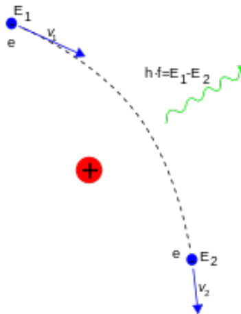
Abbildung 71: Eine schematische Darstellung der Bremsstrahlung.
