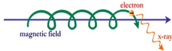
Abbildung 72: Eine schematische Darstellung der Synchrotronstrahlung
